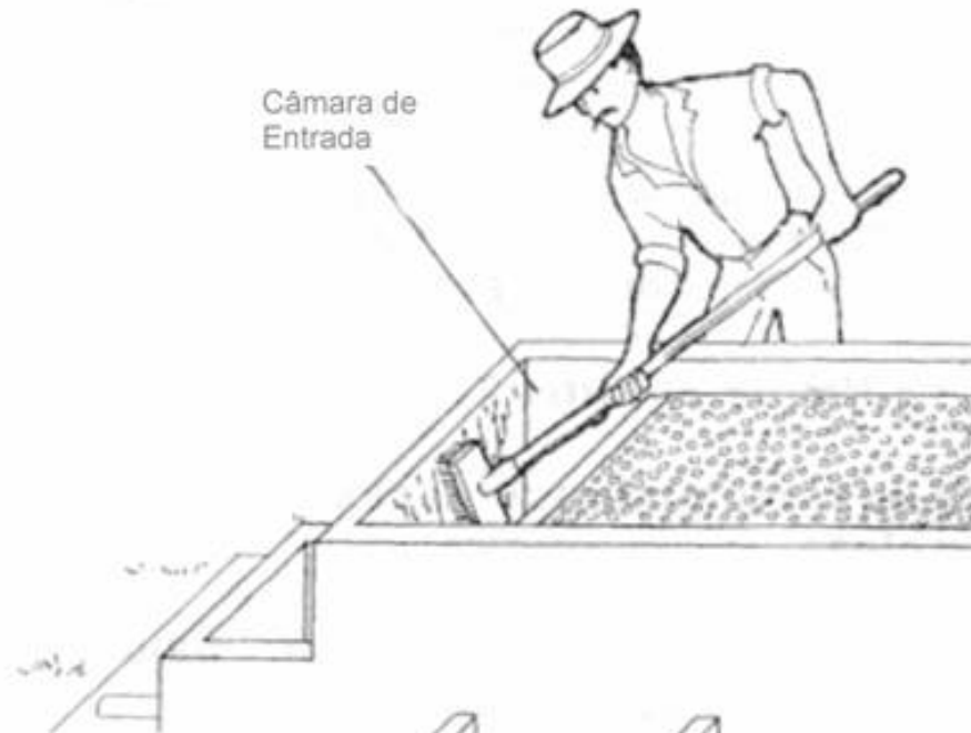
Figura 5.2: Limpeza da câmara de entrada de água bruta (Vargas et al. , 1996 - modificado)
