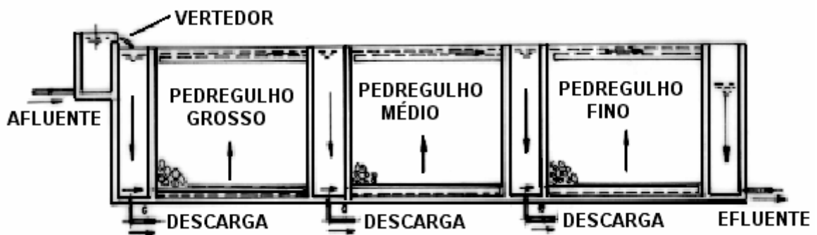
Figura 4.30 – Esquema em corte de uma Instalação de PFPAS
