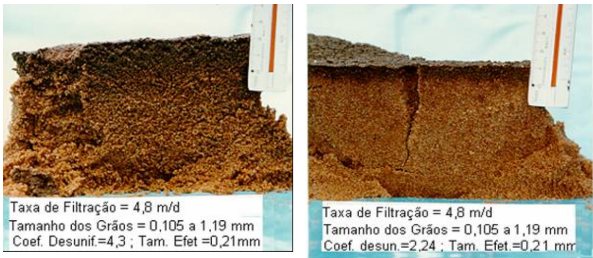
Figura 4.12 - Fotos ilustrando a espessura da camada biológica em filtros lentos de areia com diferentes coeficientes de desuniformidade (Di Bernardo e Escobar R., 1996)
