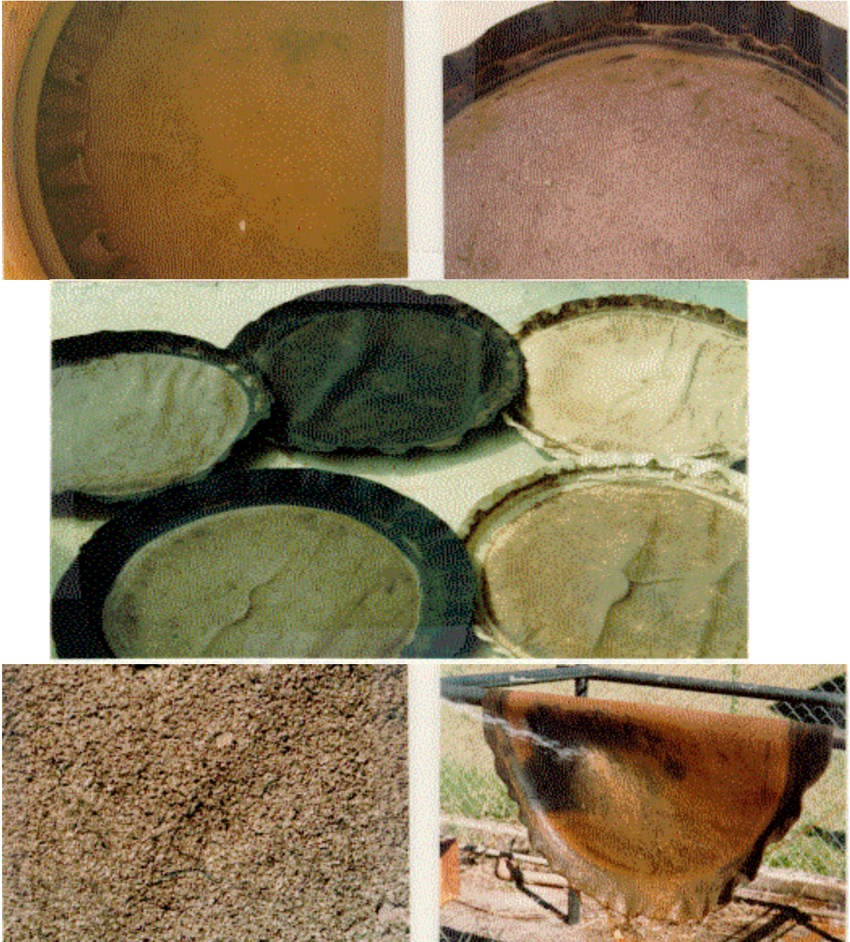
Figura 4.19 – Fotos Ilustrando a Retirada e Lavagem de Manta Sintética Disposta sobre o Topo da camada de Areia em Filtro Lento (Paterniani, 1991)
